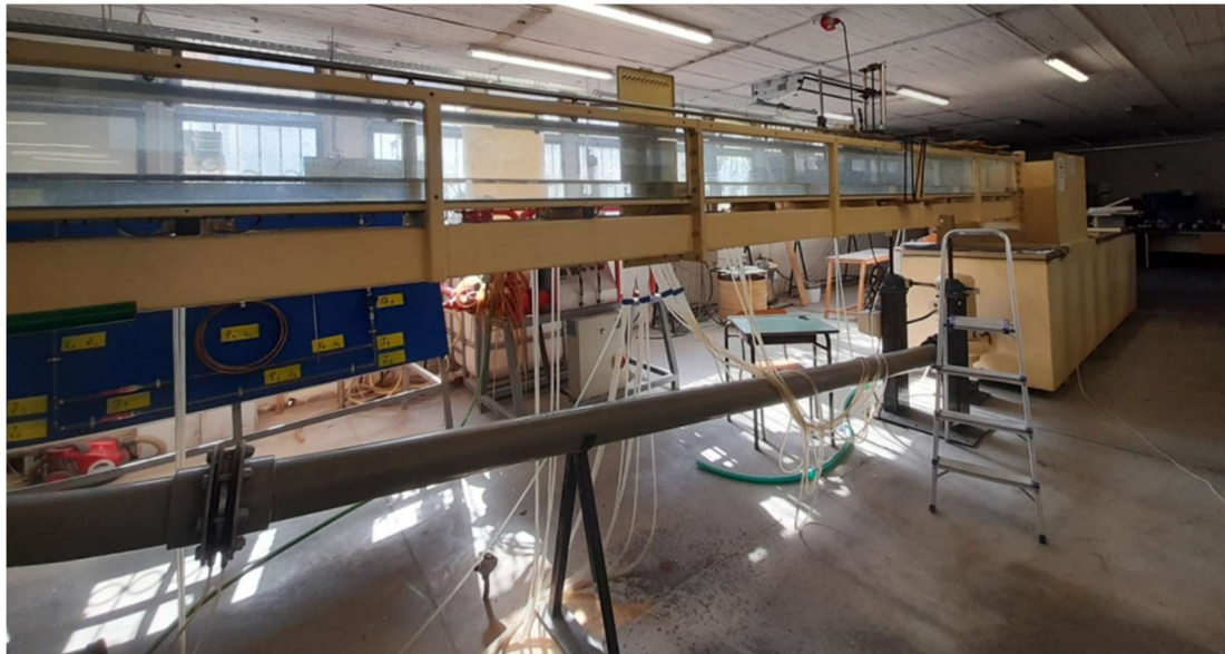
Εργαστηριακός ανοικτός αγωγός για την μελέτη ροών σε ανοικτούς αγωγούς
