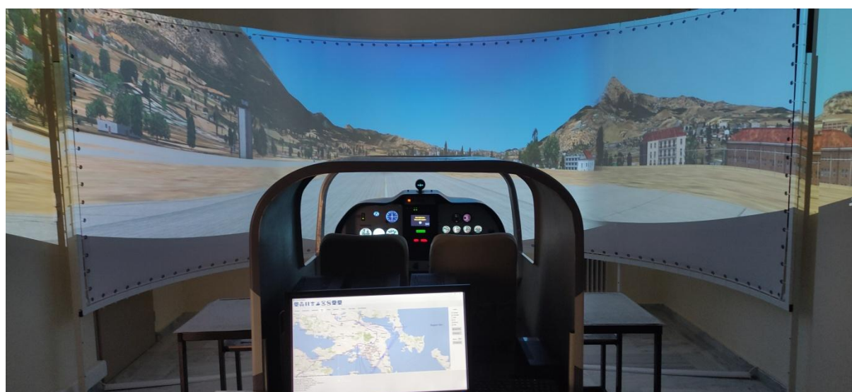
Εικόνα 3. Εξομοιωτής πτήσης εκπαιδευτικού αεροσκάφους τύπου P-2002JF.
