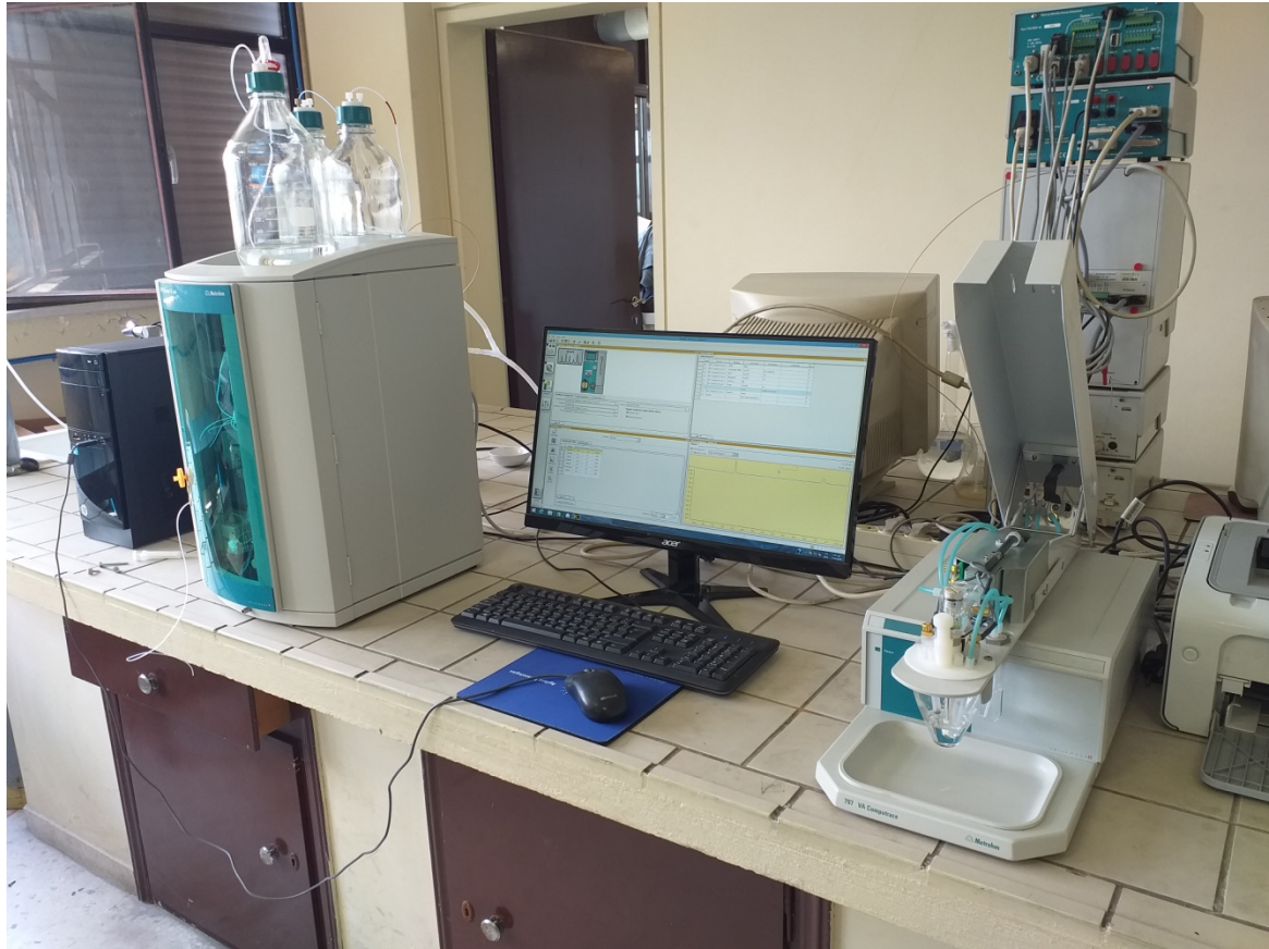
Ιοντική χρωματογραφία (αριστερά) - πολαρογράφος (δεξιά).
