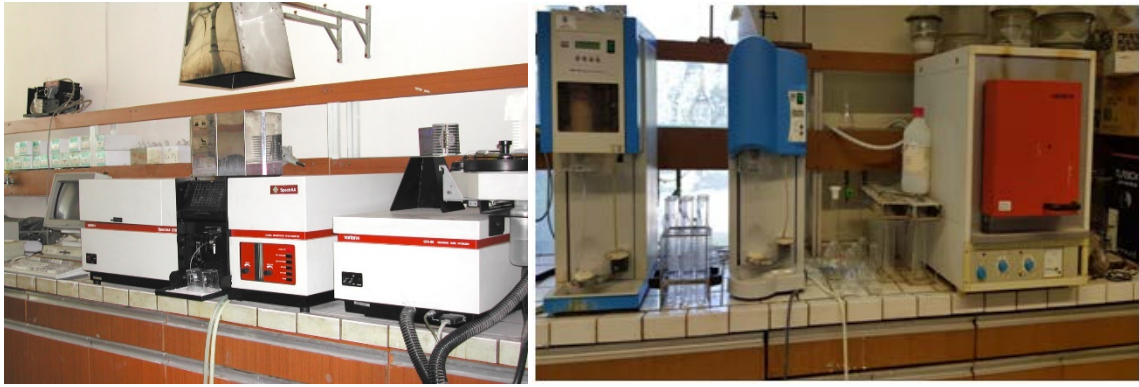
Φασματοφωτόμετρο ατομικής απορρόφησης (αριστερά) και συσκευές απόσταξης Buchi και φούρνος πύρωσης (δεξιά)
