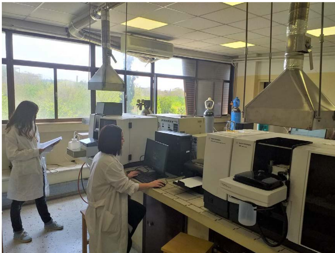
Φασματοφωτόμετρο Ατομικής Απορρόφησης - Φλόγα - Φούρνος Γραφίτη.
