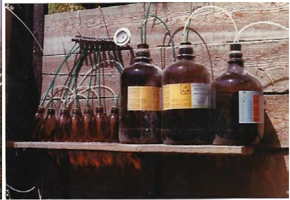
Πειραματικός αγρός Κωπαΐδας, Αλίαρτος (αριστερά). Σύστημα λήψης εδαφικού νερού (δεξιά).
