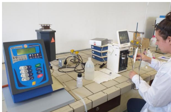
Σπεκτροφωτόμετρο (αριστερά). - Φλογωφωτόμετρο.- αυτόματος αραιωτής (δεξιά).
