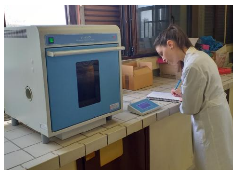
Εργαστηριακός χώρος - Συσκευή μικροκυμάτων χώνευσης εδαφών, φυτικών ιστών.
