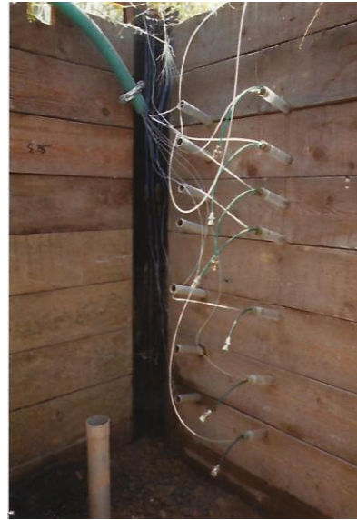
Μετρήσεις στο Αγρό: φωτοσύνθεση (αριστερά), τασιμετρα και πλακίδια βουγιούκου (δεξιά).
