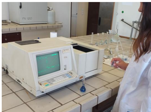
Σπεκτροφωτόμετρο (αριστερά). - Φλογωφωτόμετρο.- αυτόματος αραιωτής (δεξιά).
