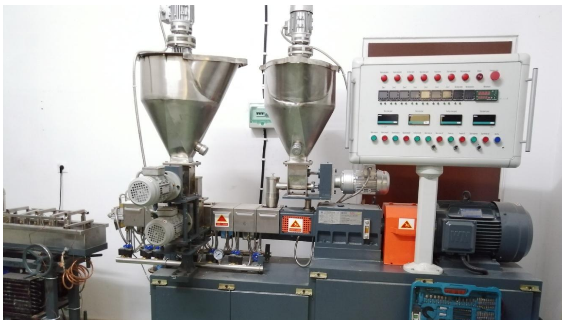
Εκβολέας (Extruder) παρασκευής πλαστικού διπλού πολυστρωματικού φιλμ.
