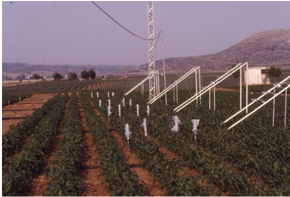
Πειραματικός αγρός Κωπαΐδας, Αλίαρτος (αριστερά). Σύστημα λήψης εδαφικού νερού (δεξιά).
