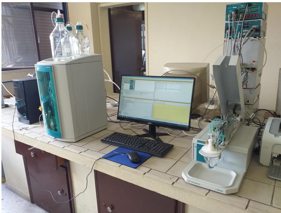
Ιοντική χρωματογραφία (αριστερά) - πολαρογράφος (δεξιά).
