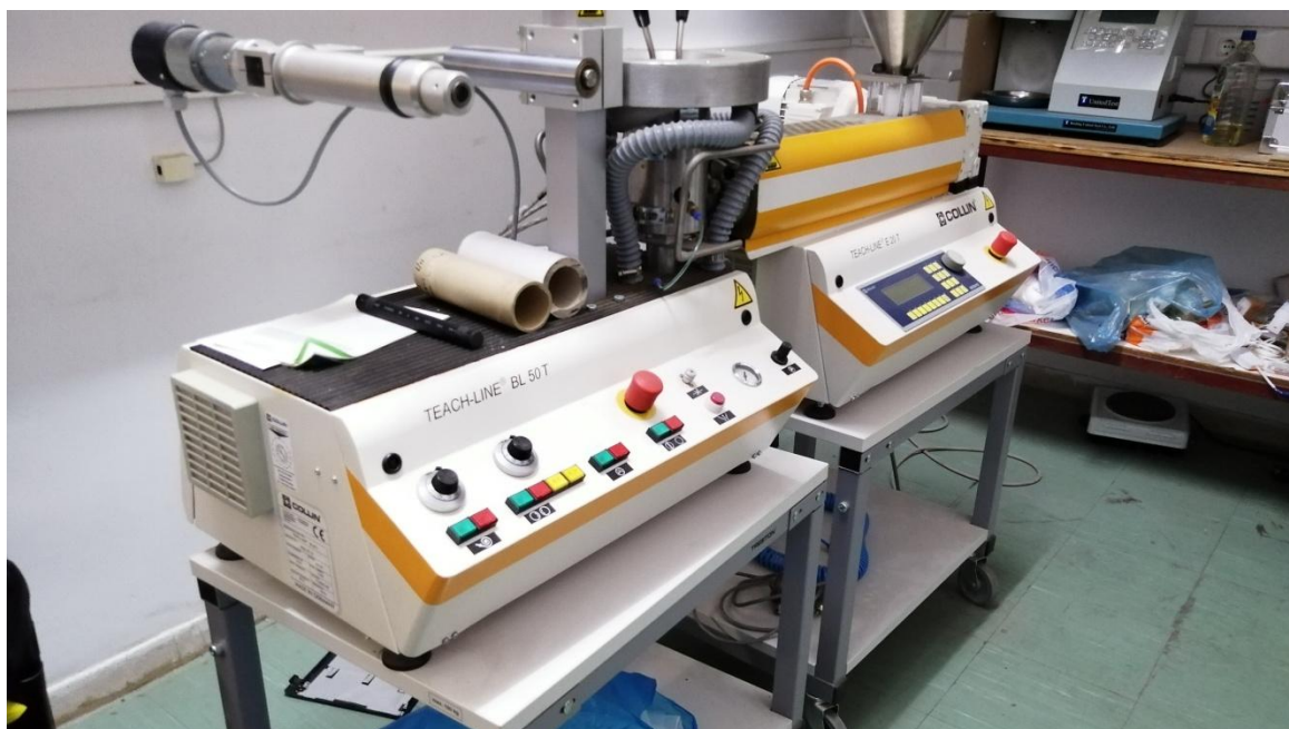
Εργαστηριακός μικρής κλίμακας εκβολέας (Extruder) παρασκευής πλαστικού φιλμ (μονό φιλμ - εργαστηριακό).
