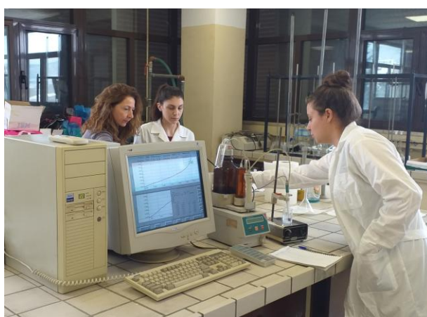
Ιοντική χρωματογραφία (αριστερά) - αυτόματος τιτλοδότης (δεξιά).
