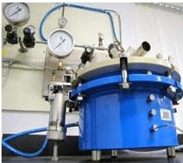
Συσκευές Προσδιορισμού Υδραυλικών χαρακτηριστικών εδαφών.
