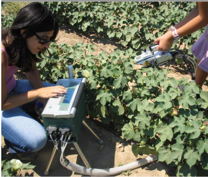
Μετρήσεις στο Αγρό: φωτοσύνθεση (αριστερά), τασιμετρα και πλακίδια βουγιούκου (δεξιά).
