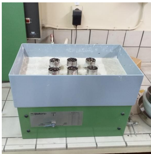
Συσκευές Προσδιορισμού Υδραυλικών χαρακτηριστικών εδαφών.
